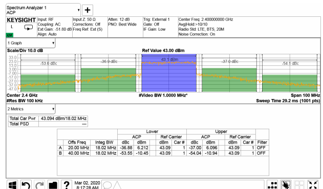
ACLR LTE20MHz PAR=9dB 2400MHz 20W 28V/2.4A
